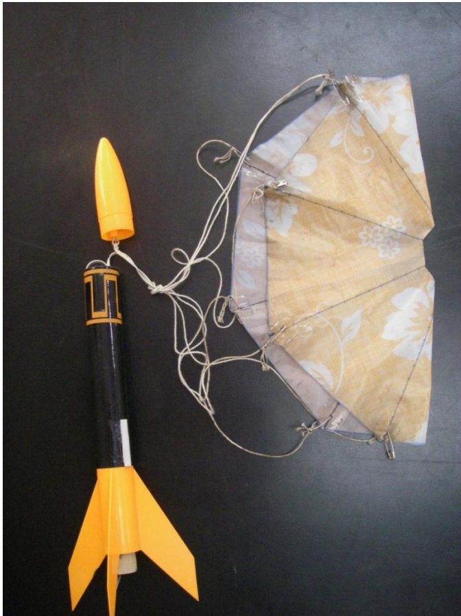
実験① Alpha IIIを打ち上げ自作パ ラシュートの安定性を調べる
