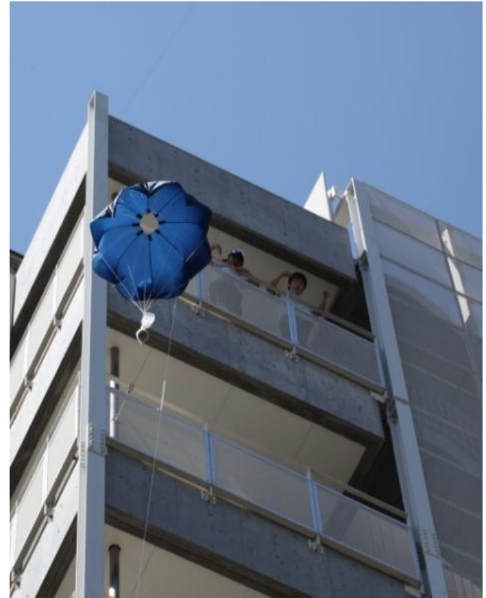
実験② 和歌山大学8階から自作パ ラシュートの降下実験
