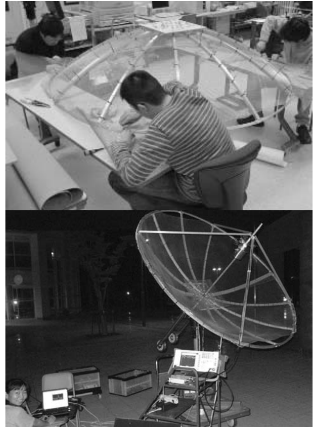
図13 上:2mパラボラ製作中の学生。下:HI輝線受信試験。
