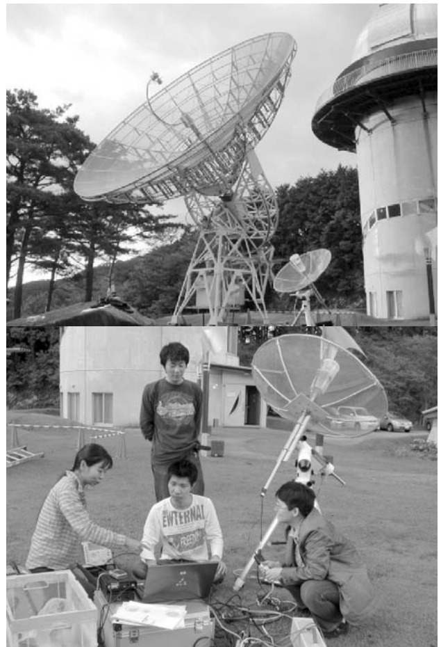
図15 近畿大学大田研究室のみさと天文台でのHI輝線観測 上：8m電波望遠鏡と近大学生製作の1m電波望遠鏡。 下：実験風景。（2010年10月10日）
