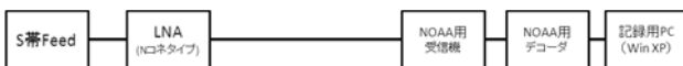
図7 NOAA衛星受信系 ブロックダイアグラム FeedとLNAを焦点部に設置。NOAA用受信機以降は観測室に設置。
