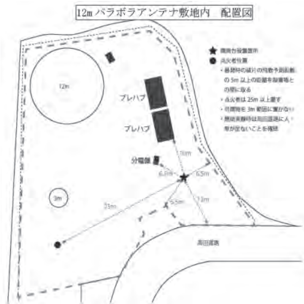
図14：学内燃焼実験時の実験配置 (和歌山大学電波観測通信施設敷地内)
