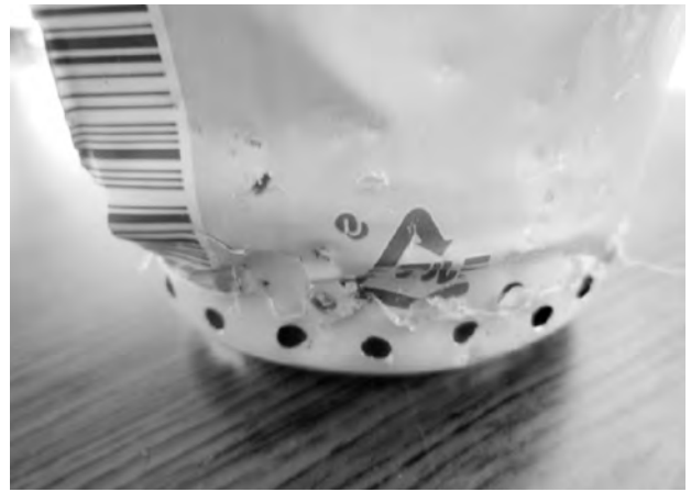
図8 落下実験時に衝撃を吸収したクラッシュブルゾーン(穴の開いている部分)
