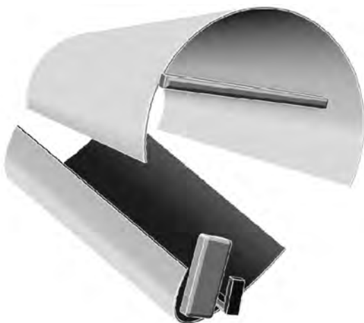
図7 キャリアが開放した様子：サーボモーターが回転し、留め具が外れ解放する。
